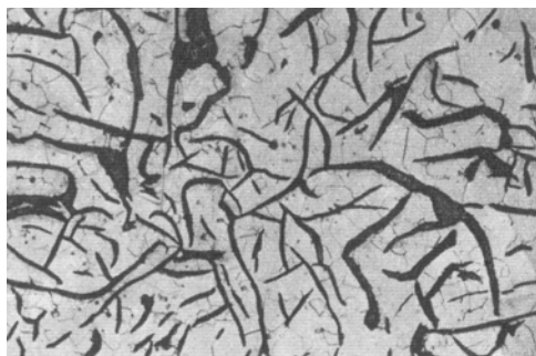
osnowa ferrytyczna, grafit płatkowy C.
